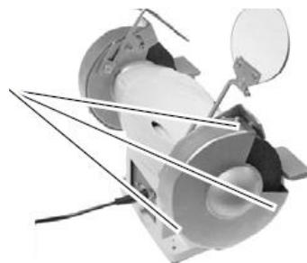
Ослабьте гайку на валу и снимите крепежный диск.
